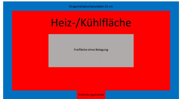
Deckensegel außenliegend mit Ringschall-Absorberplatten
